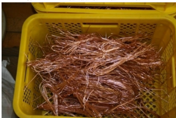
被覆材と分離され、きれいに取り出された銅線 被覆廃材もリサイクルされる
