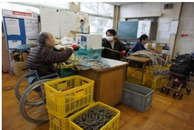
卓上型剥線機のガイド穴に手前側から廃電線を 差し込むと、ローラ回転で自動的に向こう側へ 押し出される過程で被覆材が圧縮されて壊れる
