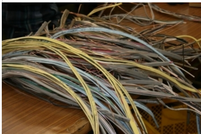
被覆材と銅線と分離しやすい状態になる
