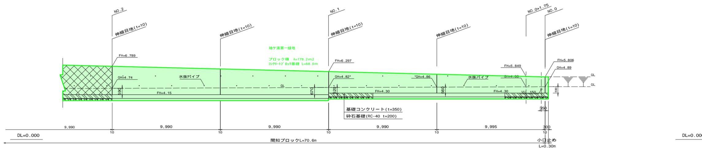
\*水抜パイプ 50mm程度の水抜孔を2.0~3.0m<sup>2</sup>に1箇所設置する。
