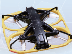
超狭小空間点検ドローン
