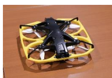
世界最小・最軽量クラスの 国産超狭小空間点検ドローン
