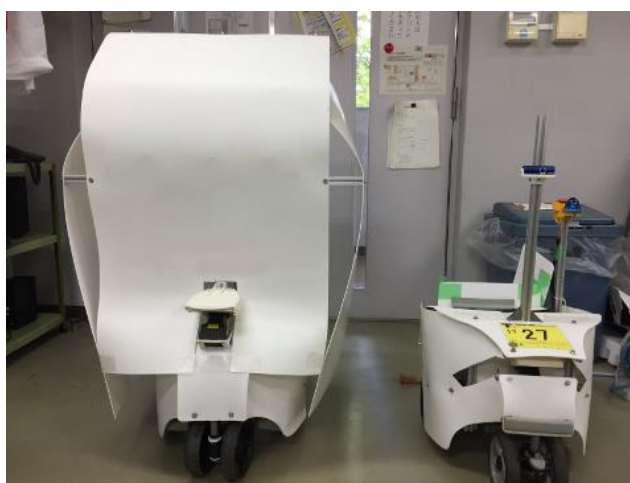
図表 3-101 歩行補助車の最大サイズとなるカバーをつけたロボット
