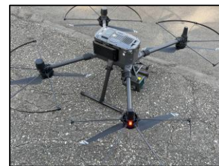
(4)UAVレーザー計測 (Matrice300 + L1)
