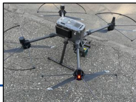
(4)UAVレーザー計測 (Matrice300 + L1)
