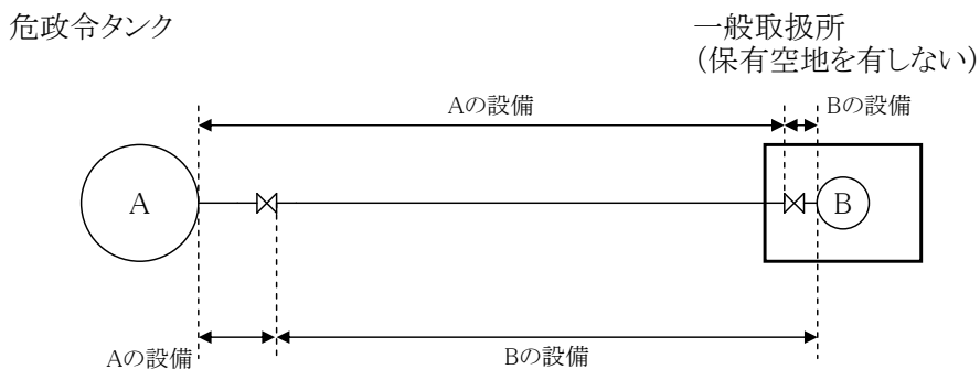
第2-1-5 図 危険物タンクと製造所（一般取扱所）の例（その3）
