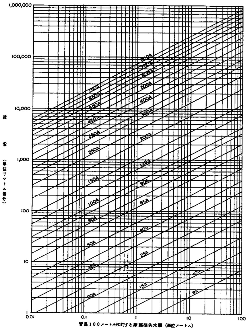
第4-5-15図 溶融亜鉛めっきを施さない配管のうち乾式の部分に用いる摩擦損失水頭線図
