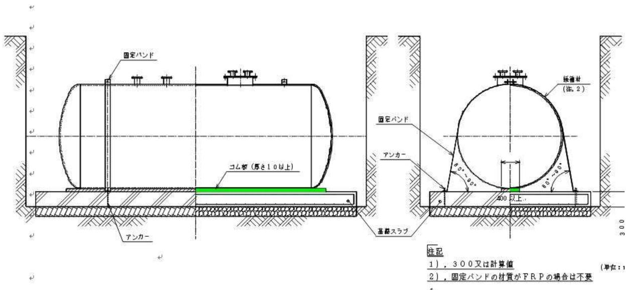
第4-18.2-2図(その2) ゴム板を用いる場合の充填砕石施工図
