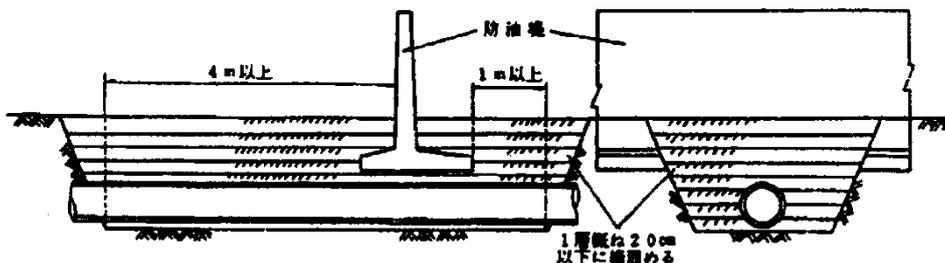
(2) 既設の防油堤の地表面下の地盤の部分を横断して新たに管きよ等を設置することはできないものであること。ただし、前記(1)イに準じて埋戻しを行い、かつ、管きよ等が横断する部分又はその上部地表面に次のうちいずれか適当な措置を講じた場合は、必要最小限の管きよ等に限り防油堤の地表面下の地盤の部分横断して設置することができるものであること。
