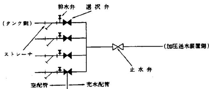
イ 選択弁等は、当該散水管が設置されるタンクの防油堤外で、火災の際安全、かつ、容易に接近することができる場所に設けること。この場合、選択弁等の操作部（ハンドル車を含む。）の位置は、操作の場所における地盤面からの高さが0.8メートル以上1.5メートル以下であること。
