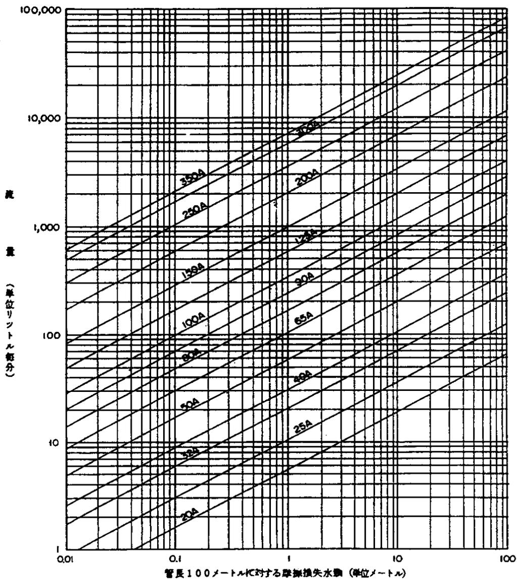
第4-5-16図 溶融亜鉛めっきを施さない配管のうち乾式の部分に用いる摩擦損失水頭線図
