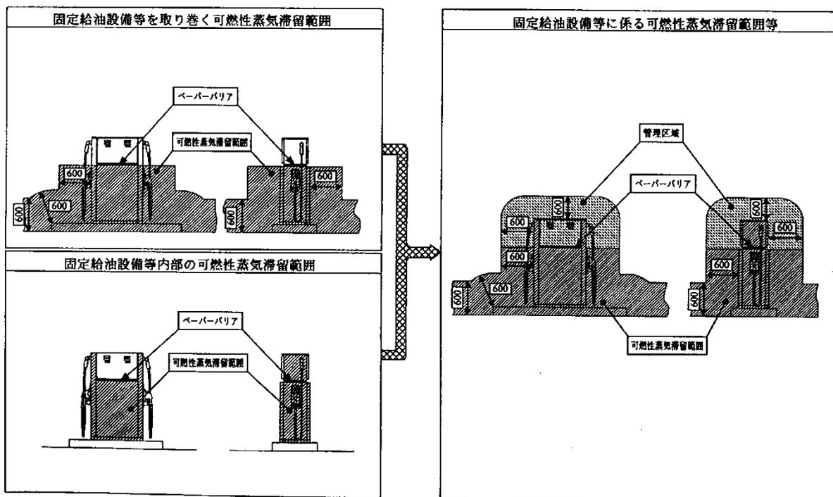
第4-7-9図 ベーパーバリアを設置した地上式固定給油設備の例3
