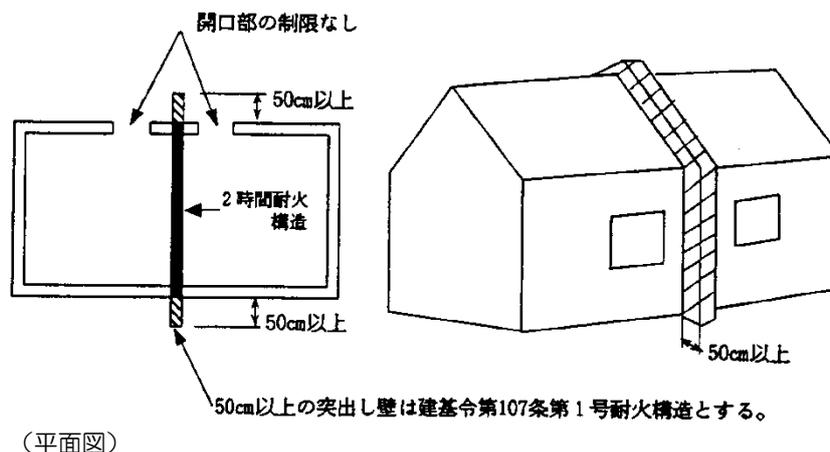
ただし、第4-10-2図から第4-10-5図までの例により令8区画を設けた部分の外壁又は屋根が、当該令8区画を含む幅3.6m以上にわたる耐火構造であり、かつ、これらの部分に開口部がない場合又は開口部がある令8区画を介して接する相互の距離が90cm以上確保され、これに防火設備（危政令第9条第1項第7号に規定する防火設備をいう。以下「防火設備」という。）が設けられている場合は、この限りではない。
