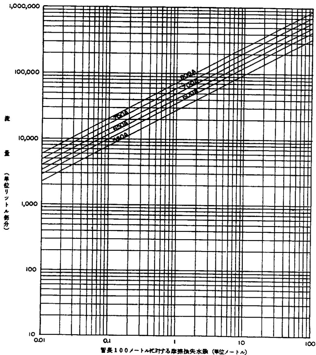
第4-5-3表 溶融亜鉛めっきを施した配管又は溶融亜鉛めっきを施さない配管のうち
