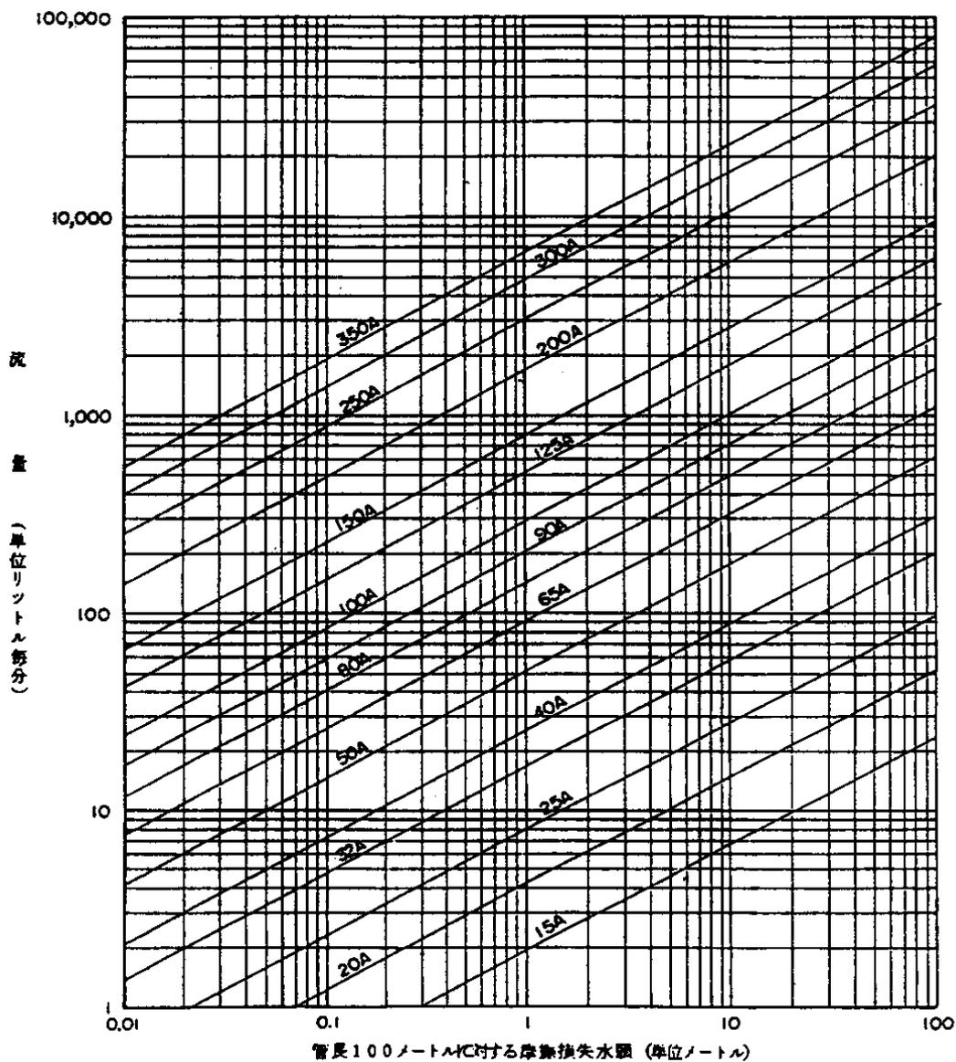
第4-5-17図 熔融亜鉛めっきを施さない配管のうち乾式の部分に用いる摩擦損失水頭線図
