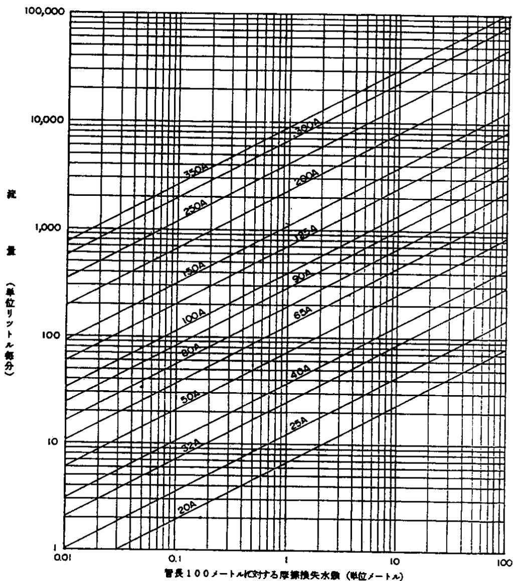
第4-5-11図 溶融亜鉛めっきを施した配管又は溶融亜鉛めっきを施さない配管のうち湿式の部分に用いる摩擦損失水頭線図
