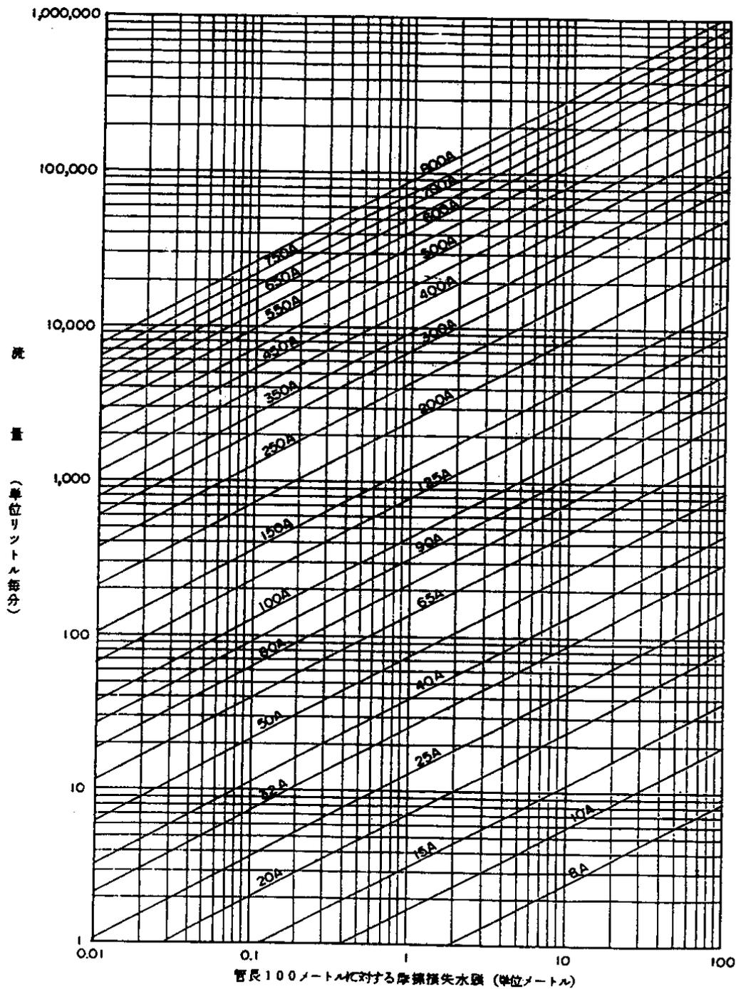
第4-5-10図 溶融亜鉛めっきを施した配管又は溶融亜鉛めっきを施さない配管のうち湿式の部分に用いる摩擦損失水頭線図
