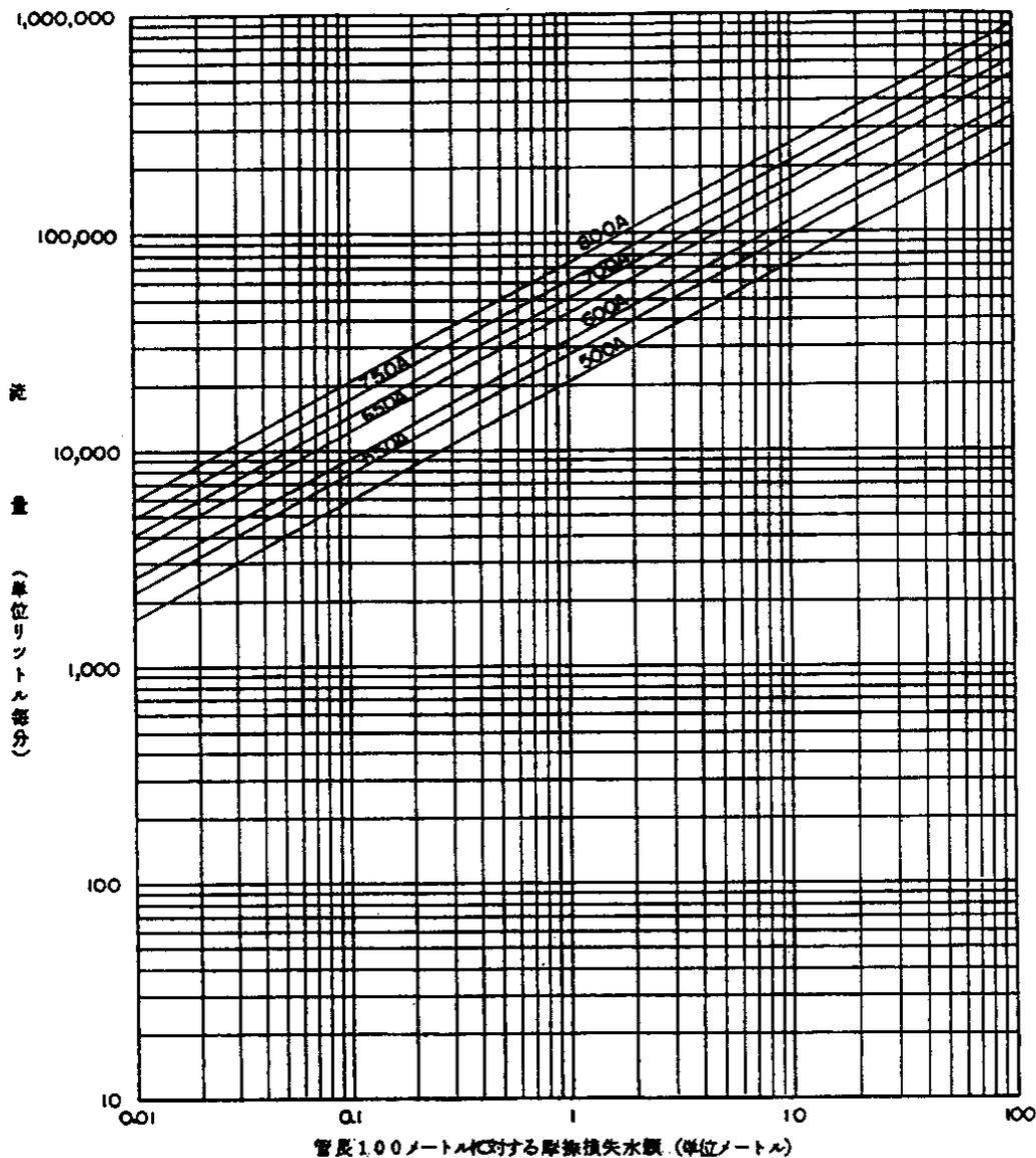
第4-5-18図 熔融亜鉛めっきを施さない配管のうち乾式の部分に用いる摩擦損失水頭線図
