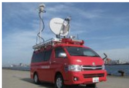
無線中継車 Radio Relay Vehicles
