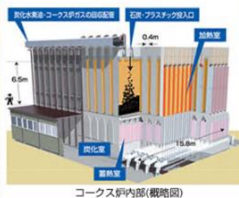
コークス炉内部(概略図)
