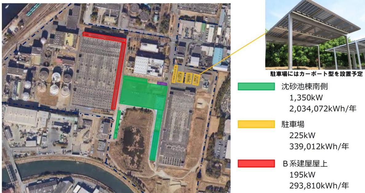
図4-1 南部浄化センターの太陽光パネル設置予定箇所と発電予定能力
