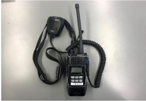
携帯型移動局 消防救急デジタル無線機
