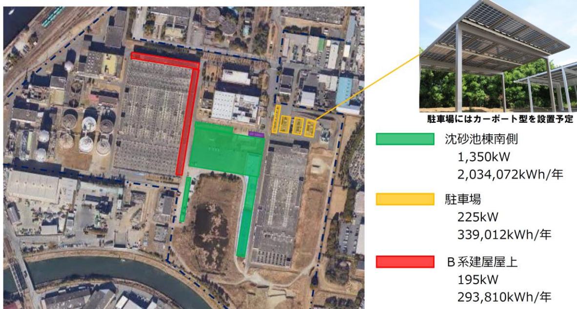
図4-1 南部浄化センターの太陽光パネル設置予定箇所と発電予定能力
