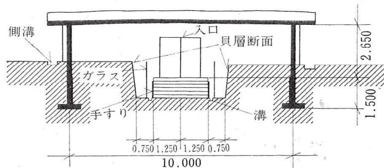
3 施設断面図 縦断面
