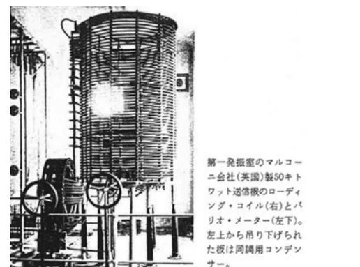
第一発振室のマルコーニ会社(英国)製50キロワット送信機のローディング・コイル(右)とバリオ・メーター(左下)。左上から吊り下げられた板は同調用コンデンサー。
