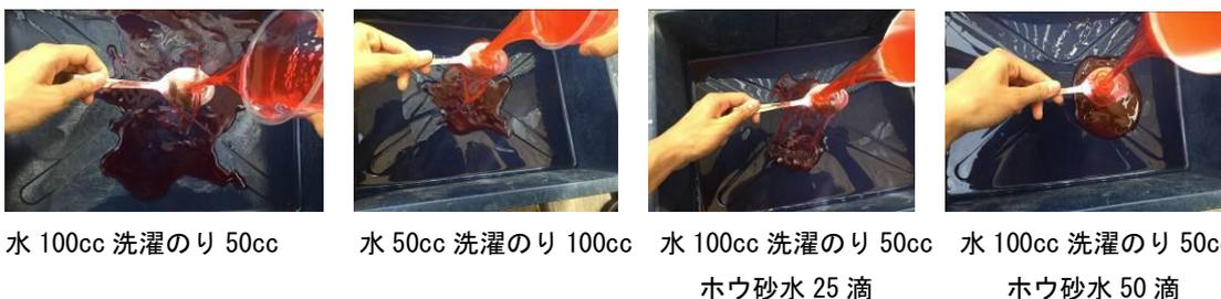
〔資料3〕 粘り気のある液体での水流の膜の作り方
