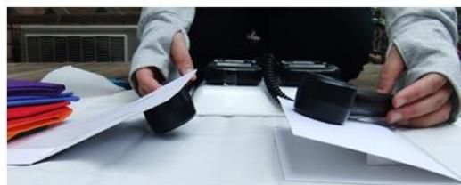
実験を行った8月の太陽高度を調べた。その高度の太陽光に対して、測定器のセンサーが垂直になるようにするため、センサーが傾かないように、左図のような厚紙の固定装置を作成して測定する。
