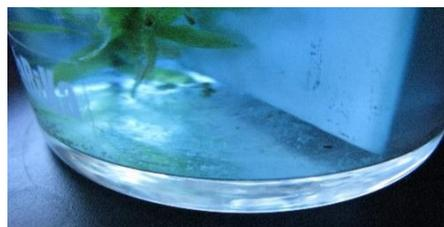
写真 13 : 24 時間後ガラス容器の底に見えた白い沈殿  $Al(OH)_3$
