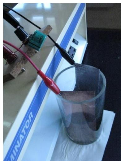
写真 8: コンデンサーにつなげて充電している様子
