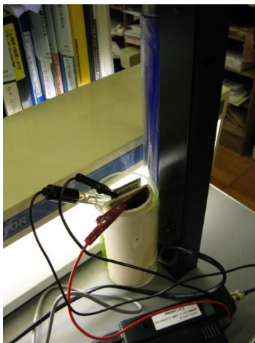
実験 6：オオカナダモ電池の電極に電圧センサーをつなげて計測している様子。
