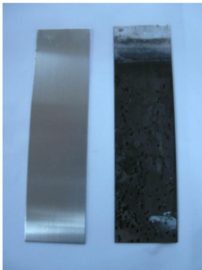
写真 16 : 左 最初の Mg 合金電極板 重さ 10.68 g      右 1 ヶ月連続使用の Mg 合金電極板 重さ 10.63 g
