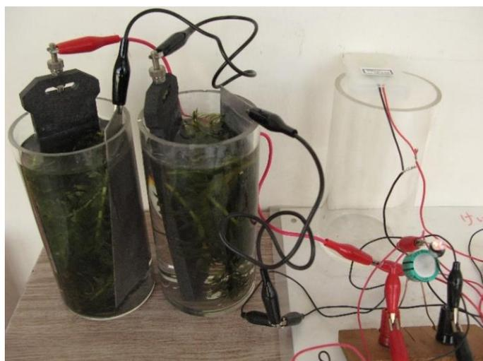
写真 14 : 実際のMg - オオカナダモ電池の様子
