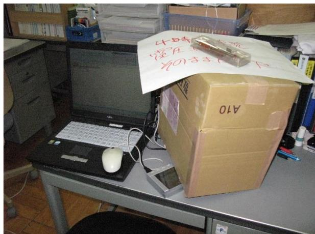
写真 10-11 : 実際にデータロガーで自動計測している様子。LEDランプは箱を被せた。
