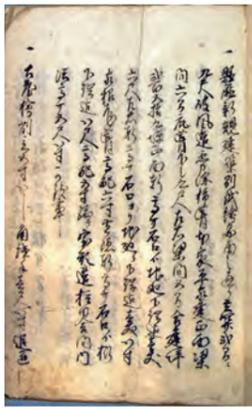
図3 『県庁新規建築仕様帳』1頁より。1行目「縣廳新規建築別紙絵図面之通り……」、左端は「土台檜削立五寸八分角継手壹尺八寸追懸」と読める。
