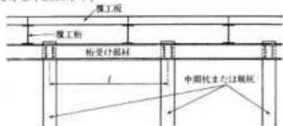
図 7.10.5 桁受け部材の支間
