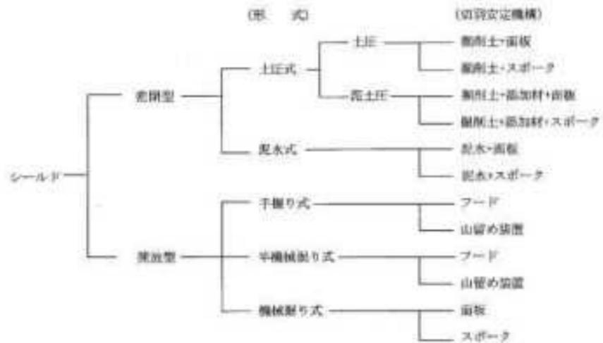
図 9.1.1 推進工法の分類
