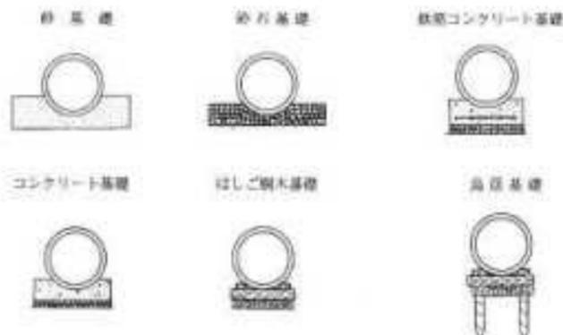
図 4.6.1 剛性管きよの基礎の種類
