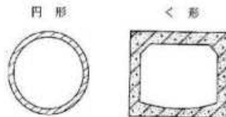
図 4.2.1 管きよ断面の種類
