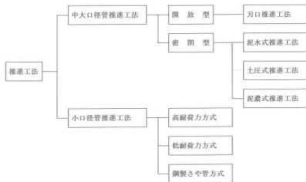
図 8.1.1 推進工法の分類
