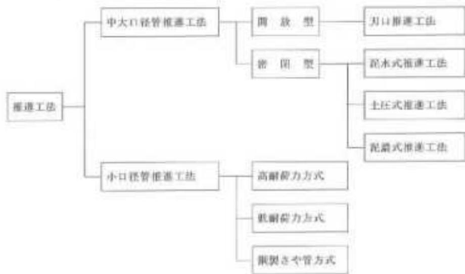
図 8.1.1 推進工法の分類
