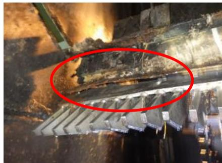
レーキ部分の腐食、変形
