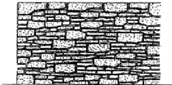
(2) 受注者は、天端石のある場合は、天端石に大きい石材を使用し、稜線が通るように施工しなければならない。
