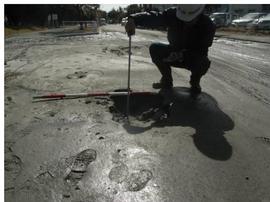
写真3-8 被害状況（美浜区高浜）
