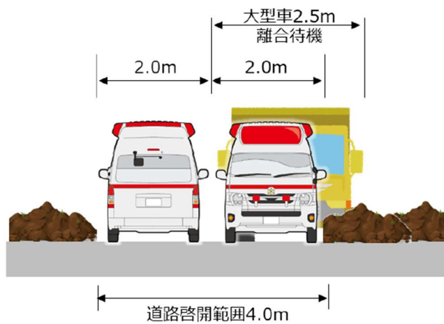
図 3. 22 最小啓開幅員イメージ
