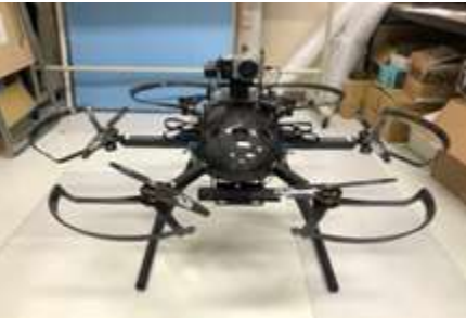
写真5 橋梁点検（ドローン）
