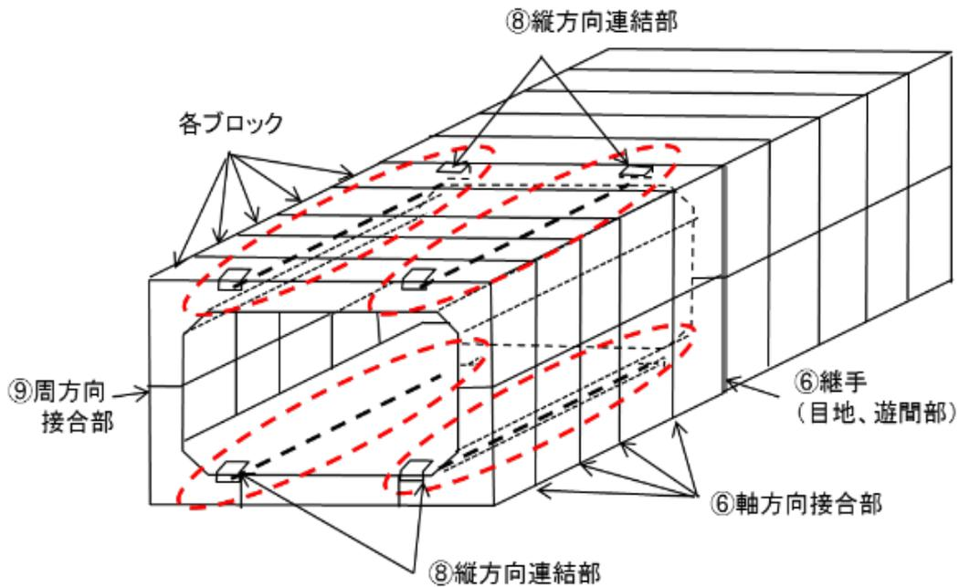
・ 接合部は、プレキャスト部材同士が接合している部位を指し、軸方向接合部と周方向接合部がある。また、連結部は縦方向連結部とその定着部を指す。
