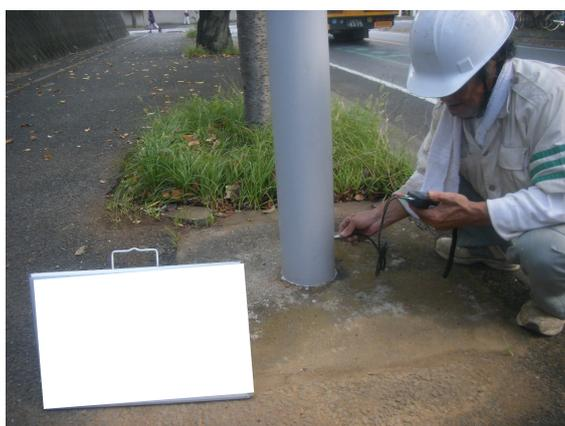
図 3-7 残存板厚測定実施のイメージ
