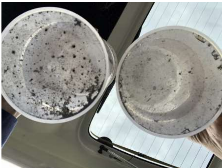
写真 2.4-1 フェスティバルウォーク蘇我(左)と千葉職業能力開発短期大学校(右)の降下ばいじん検体(令和元年5月分)(令和元年5月31日 底側から撮影)
