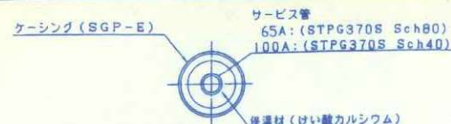
蒸気管・還水管標準断面図（埋設）
