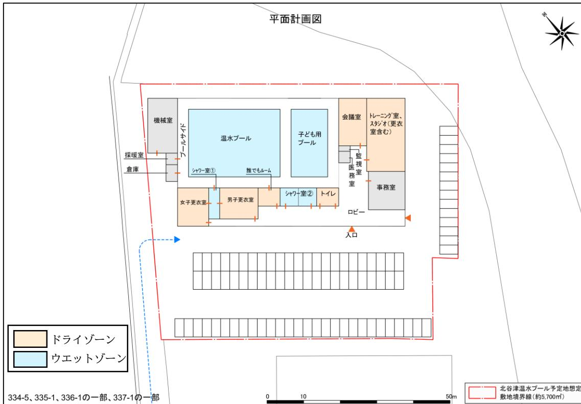
図: 余熱利用施設(プール)の平面計画図
