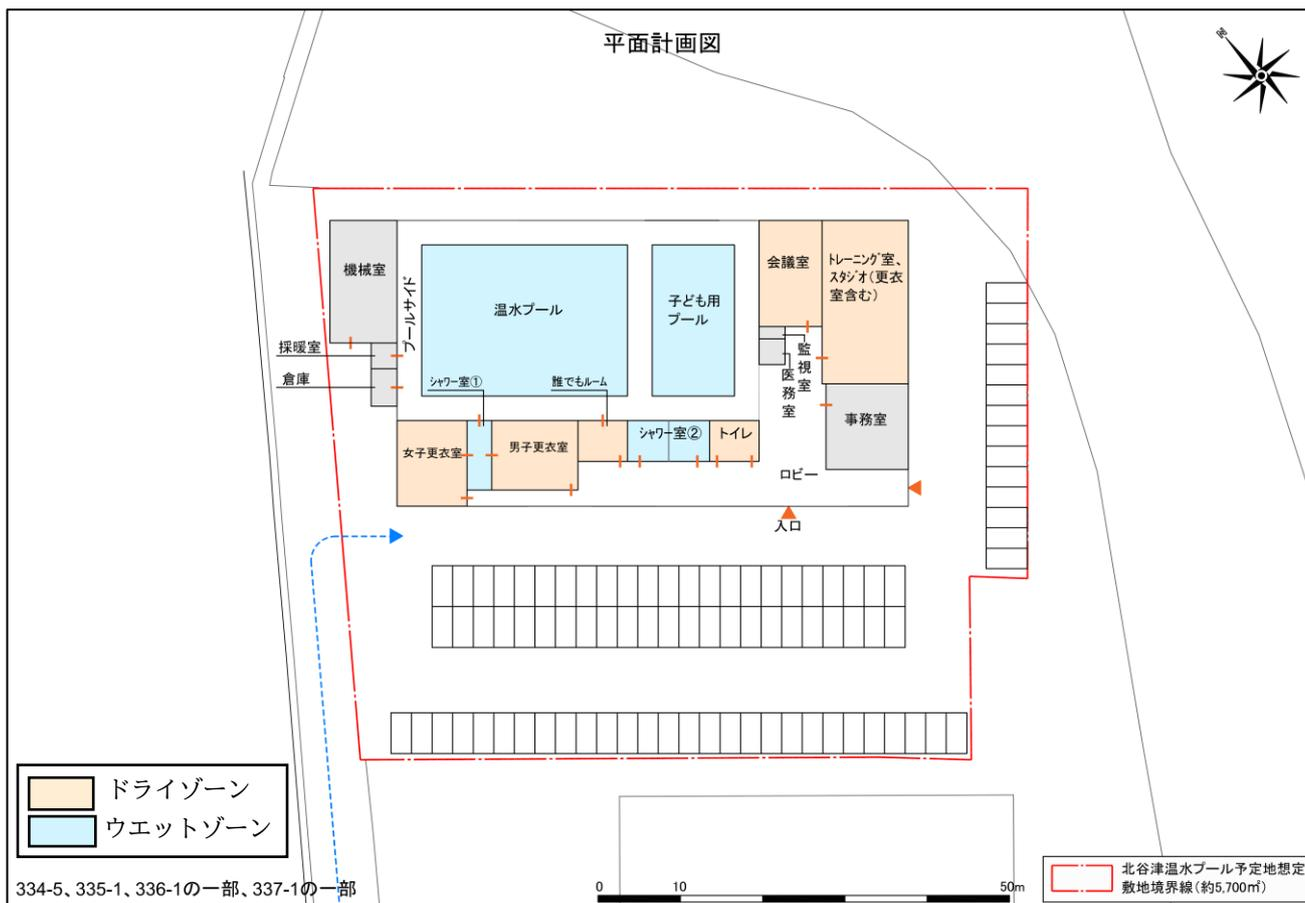
図11. 余熱利用施設の平面計画図
