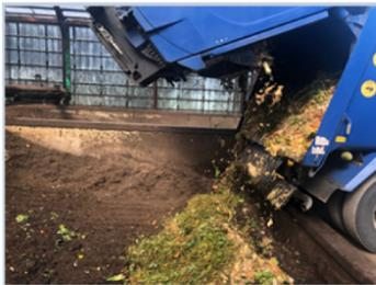
捨てない+燃やさない+埋め立てないをコンセプトに、回収してきた生ごみを発酵槽へ投入
