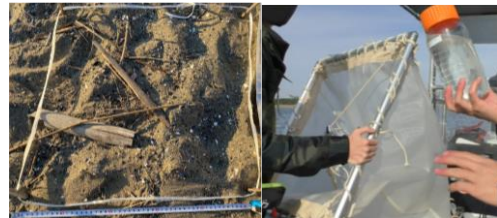
写真 4 マイクロプラスチックの砂浜サンプリング(左)と海水サンプリング(右)
