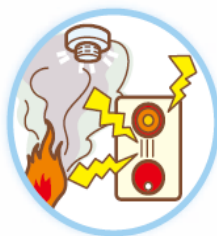
自動火災報知設備
