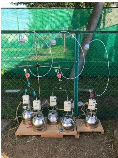
左の写真は、有害大気汚染物質調査の一例です。キャニスターという大気試料を捕集する容器を使って、24時間2時間毎に捕集します。(写真3) 捕集後は、ガスクロマトグラフ質量分析装置という分析機器を用いて揮発性有機化合物(ベンゼンなど)の測定を行っています。
